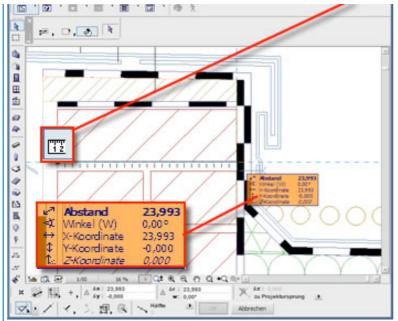
(Im Beispiel wurde eine Detailzeichnung geöffnet - die Wandstärke wird statt mit 0,24 m mit 24 Metern angezeigt.)
